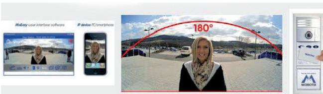
Il software di controllo permette durante il servizio notte di scattare una foto ad ogni visitatore che suona al videocitofono e di registrare a 180° soltanto le immagini in movimento che attraversano il campo di azione delle telecamere o dei videocitofoni. E' possibile il controllo e la risposta da tablet o smartphone e la gestione accessi tramite Smartcard Reader RFID.
